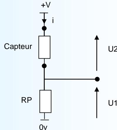
RP correspond à la résistance (interne au module) de polarisation de la sonde.
