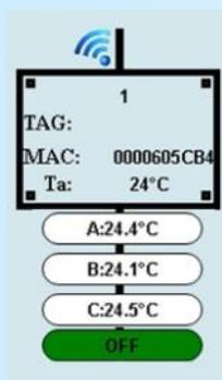
Pour chaque émetteur est construit une sorte de grappe qui contient tous les 3 points de mesures de l'émetteur. L'affichage de la température est au 1/10em °C.
